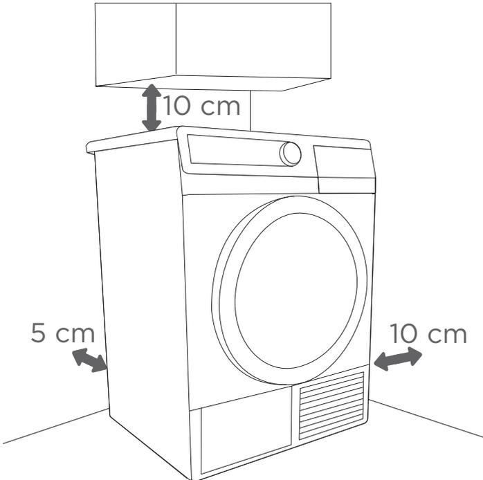
Die Entlüftungsslitze und die Öffnung an der vorderen bzw. hinteren Gerätewand des Wäschetrockners müssen freigehalten werden.
