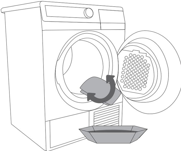
Reinigen Sie vor dem ersten Gebrauch des Trockners die Trommel mit einem weichen Tuch und einem schonenden Reinigungsmittel.
