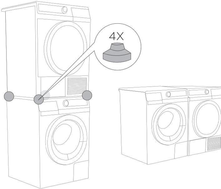
Aufstellung des Wäschetrockners auf der Waschmaschine unter Verwendung von Vakuumfüßen oder Aufstellung neben der Waschmaschine.
