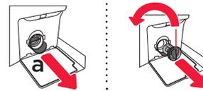
**2** Vor der Reinigung des Filters entnehmen Sie den Auslauffrichter (a). Den Filter stufenweise gegen den Uhrzeigersinn drehen (b). Entnehmen Sie den Filter um das Wasser langsam auslaufen zu lassen.
