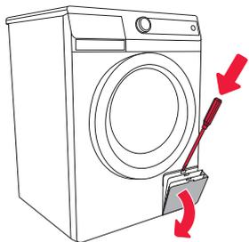
**1** Öffnen Sie die Filterabdeckung mit einem Werkzeug (Schraubenzieher oder ähnliches).
