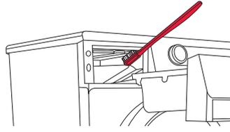
**2** Waschmaschine, besonders die Düsen auf der oberen Seite der Kammer für das Auswaschen, sollten Sie mit einer Bürste reinigen.
