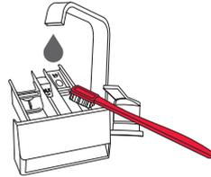
**2** Unter fließendem Wasser reinigen Sie das Dosiergefäß mit einer Bürste und trocknen Sie es. Beseitigen Sie auch die Waschmittelreste vom Boden des Gehäuses.
