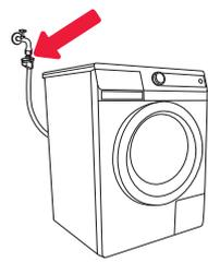
**1** entnehmen Sie die Gitter aus der Zuleitung.
