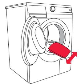
**3** Nach jedem Waschvorgang wischen Sie die Gummidichtung an der Tür ab.
