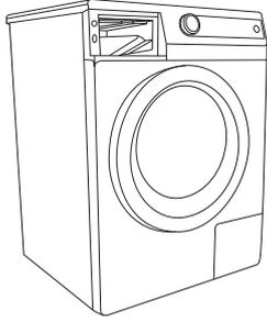
**1** Bevor Sie das Dosiergefäß wieder zurücksetzen, sollten Sie noch den Auswaschbereich reinigen.
